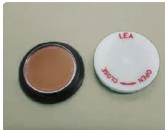
Source de diamètre actif 40 mm déposée dans la coupelle client de diamètre 47 mm 1.6 in (40 mm) active diameter source deposited in 1.9 in (47 mm) diameter customer planchet.
