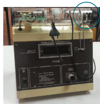
Photo d'un CRAB. La source, de type disque, est repérable par le trèfle radioactif et la chaîne © CEA / JEULIN
