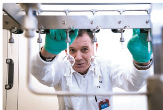
Remplissage d'une ampoule de ^{85}\text{Kr} © LEA Filling a ^{85}\text{Kr} ampoule
